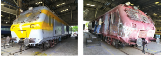
डीजल पावर कार का निरीक्षण यान में रूपांतरण का कार्य
